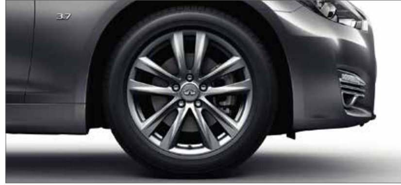
عجلات من سبائك الألمنيوم قياس 18 X 8.0 بوصة بخمسة أضلع داخلية مزدوجة
